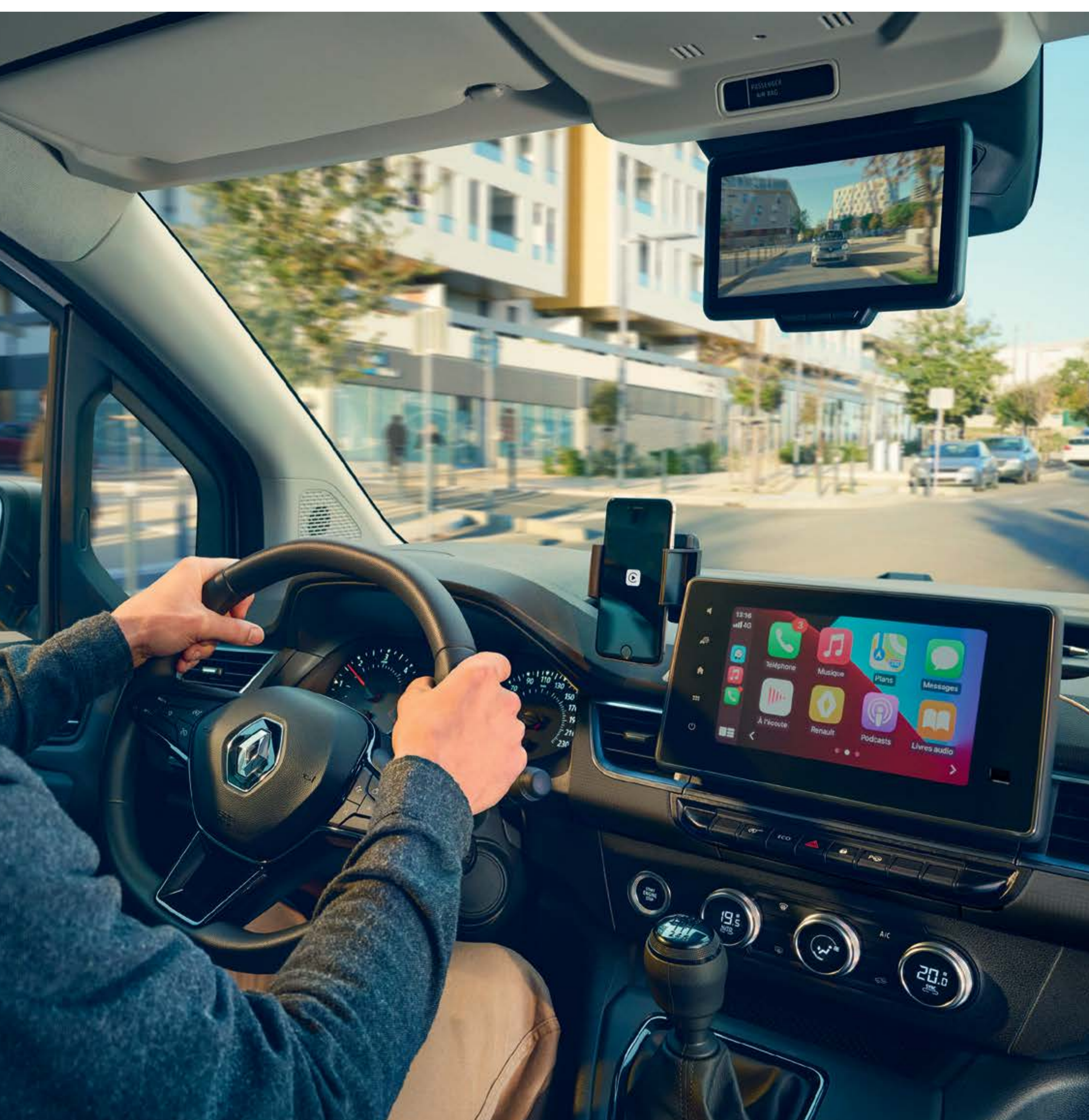
stalen prikaz območja za vozilom (1) , nosilec za pametni telefon in brezžični prikaz zaslona pametnega telefona
